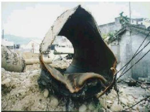
圖 1-6 2000MM 送(輸)水鋼管損壞情形
