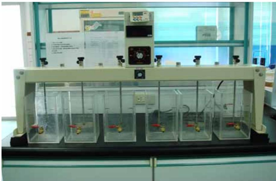
圖 4-3 杯瓶試驗機
