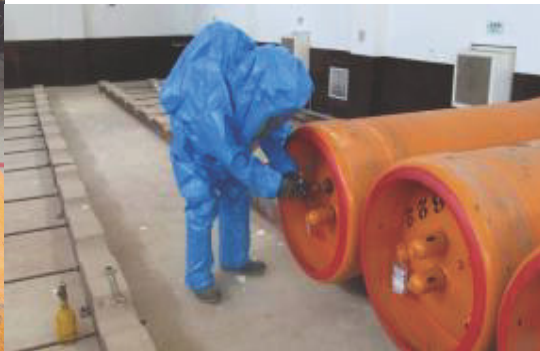
圖 5-5 閥出口漏氣止漏
