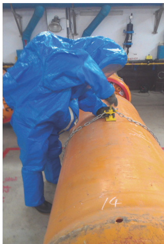
圖 5-4 器壁漏氣止漏
